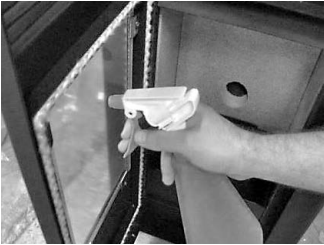
Figura 20– Limpieza incorrecta del vidrio
